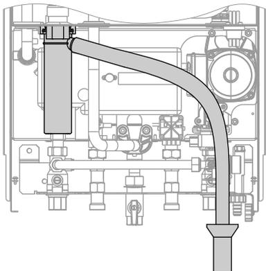
1. Извлечь сливной шланг конденсата из водогрейного котла настолько, чтобы внутри водогрейного котла не образовывалось ненужных изгибов. Обеспечить надежное подключение шланга к сифону.
